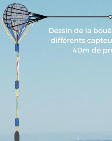
Dessin de la bouée Hypatia et ses différents capteurs à 1m, 30m et 40m de profondeur
